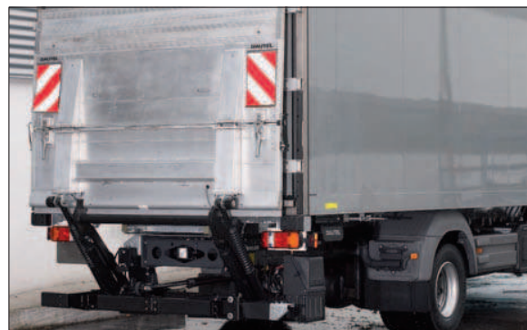
2-częściową platformę można również ustawić pionowo
